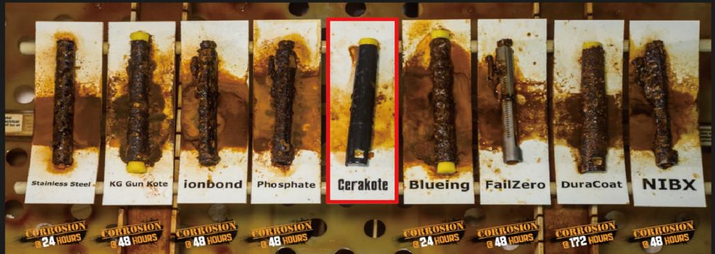
CeraKote™ 製品によっては5%の塩水噴霧連続暴露試験で
